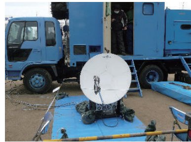
松島基地に設置した可搬局
