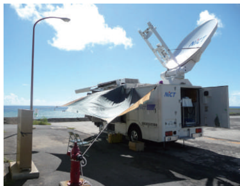
日食実験時の硫黄島に設置した地球局
