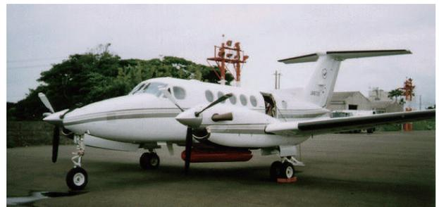
ビーチクラフトに搭載された CAMPR。胴体の下に見える赤い部分がアンテナレドーム。
