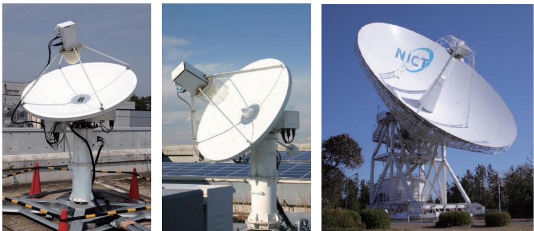
図2 VLBI周波数比較プロジェクトにおいて広帯域アンテナとして開発している1.6m(産総研)、1.5m(NICT小金井)の小型アンテナと、広帯域フィードを搭載した34mアンテナ
