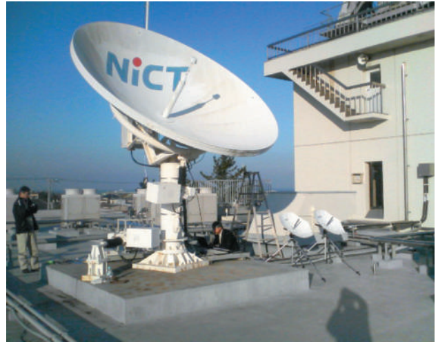
携帯端末を使用した通信実験風景 2010年12月撮影 音声通話やデータ通信が可能な携帯端末を使用して、64kbpsのデータ伝送実験を行っているところ。
