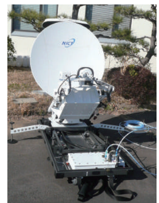
WINDS 用フルオート可搬型地球局 2013年撮影 誰でも簡単な操作で人工衛星通信設定が可能で持ち運びも容易な地球局を開発した。
