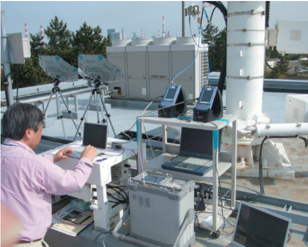
PDA 型携帯端末を使用した通信実験風景 2010年4月撮影 音声通話やデータ通信が可能なPDA型携帯端末を使用して、QPSK変調方式によるデータ伝送実験を行っているところ。
