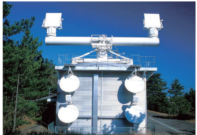
可動基線電波干渉計 2010年撮影 人工衛星の電波を受信し位置や軌道を特定する実験を行っていた。
